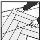
En utilisant un cutter ou une scie plongeante réglée à 5mm de profondeur, coupez sur la ligne déjà tracer, gardez les chutes pour l'autre bout de la pièce.
