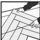
Luego, con una cuchilla plegable o una sierra de inmersión ajustada a 5 mm, corte con cuidado por la línea marcada. Guarde el triángulo resultante del corte para usarlo en el otro extremo de la habitación.
