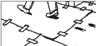
Solange die Bauarbeiten nicht abgeschlossen sind sollte der verlegte Belag mit Folien etc. geschützt werden. Die Reinigung beginnt vor der Tür. Als vorbeugende Maßnahmen sind ausreichend dimensionierte Sauberlaufzonen in Eingangsbereichen unerlässlich. Dadurch wird das Eintragen von Schmutz wesentlich vermindert. Sie sollten bereits bei der Planung eines Objekts berücksichtigt werden, da sie sich entscheidend auf die Lebensdauer des Bodens und die Wirtschaftlichkeit der Reinigung auswirken.
