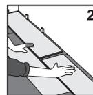
Stellen Sie mit Hilfe einer temporären Fliese sicher, dass Fliesen in der ersten Reihe perfekt ausgerichtet sind. Richten Sie die zweite Fliese aus und klopfen Sie sie sanft mit einem Hammer an die richtige Stelle, wenn Sie sicher sind, dass es quadratisch ist.
