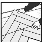
Verwenden Sie anschließend ein Allzweckmesser oder eine Tauchsäge, die auf 5 mm eingestellt ist, um vorsichtig an der markierten Linie entlangzuschneiden. Behalten Sie das abgeschnittene Dreieck zur Verwendung am anderen Ende des Raumes.
