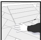
Verbinden Sie vier Planken und verwenden Sie diese als Orientierungspunkt. Markieren Sie dies dann an der Wand über die gesamte Länge mit einem Bleistift, wie unten gezeigt.
